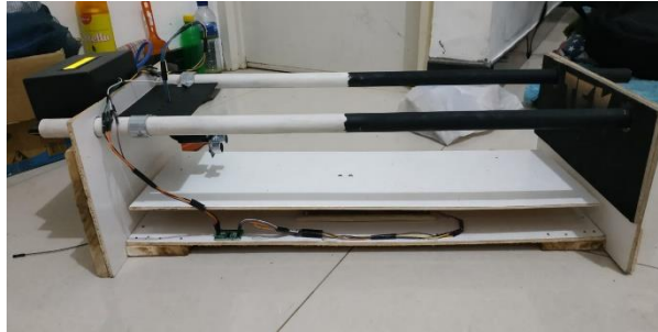
Gambar 2 Hasil Rancang bangun alat pengukur Panjang dan berat ikan
